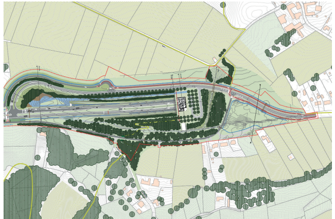
Ontwerpplan van de tunnelmond in Maarkedal waarbij de N60 onder de Schavaart door richting Ronse verderloopt.
